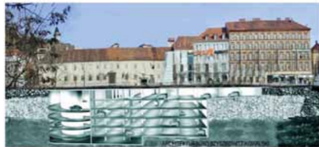
IL. 1. WIZUALIZACJA PODBUDOWY POD ISTNIEJĄCĄ ZABUDOWĄ W GRAZU. ŹRÓDŁO: HTTP://INZYNIERIA.COM/UPLOADS/IMAGES/ORIGINAL/UYQTWWQRZEUETWLHQZEPRQERKIPOUKMVPBRPIVZMDSJOHFRSPALJSBPVDKAP.JPG (DATA POBRANIA 14.01.2016)
