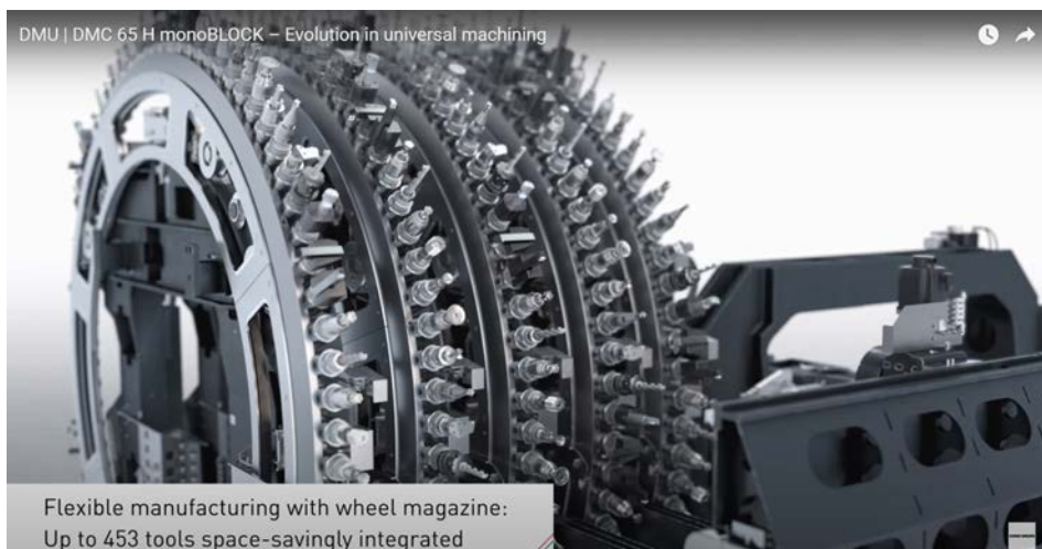
Rysunek 2.25. 5-tarczowy magazyn narzędzi firmy DMG MORI
