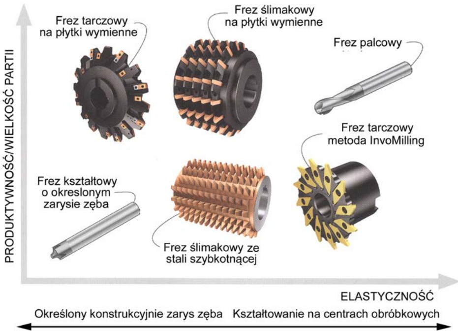
Rysunek 3.38. Rodzaje i możliwości metod nacinania zębów, firma Sandvik Coromant
