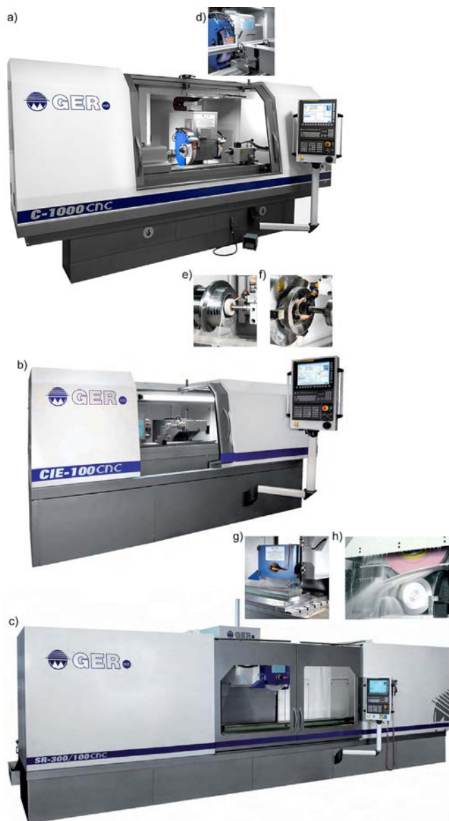
Rysunek 2.7. Przykłady wykorzystania szlifierek CNC: (a) szlifowanie wałów, (b) szlifowanie otworów, (c) szlifowanie płaszczyzn, d) szlifowanie długiego wału z zastosowaniem podtrzymki, (e) i (f) mocowanie pierścieni, odpowiednio: bezuchwytowe i uchwyty, (g) strefa szlifowania powierzchni płaskiej, (h) profilowanie ściernicą rolką diamentową
