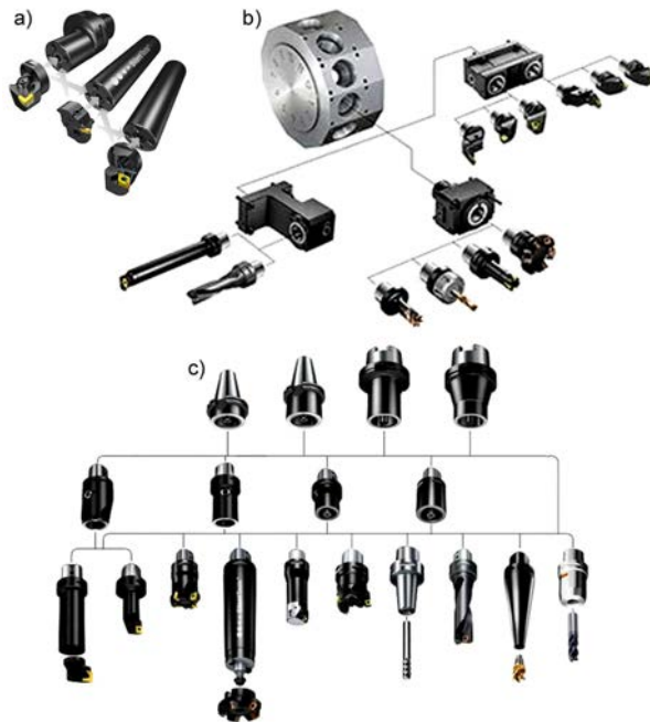
Rysunek 4.22. Systemy mocowania narzędzi firmy Sandvik Coromant: (a) wymienne oprawki do mocowania wkładek nożowych, (b) adaptery do mocowania w głowicy rewolwerowej narzędzi z chwytem Capto, (c) oprawki i adaptery do mocowania narzędzi na frezarskich centrach obróbkowych
