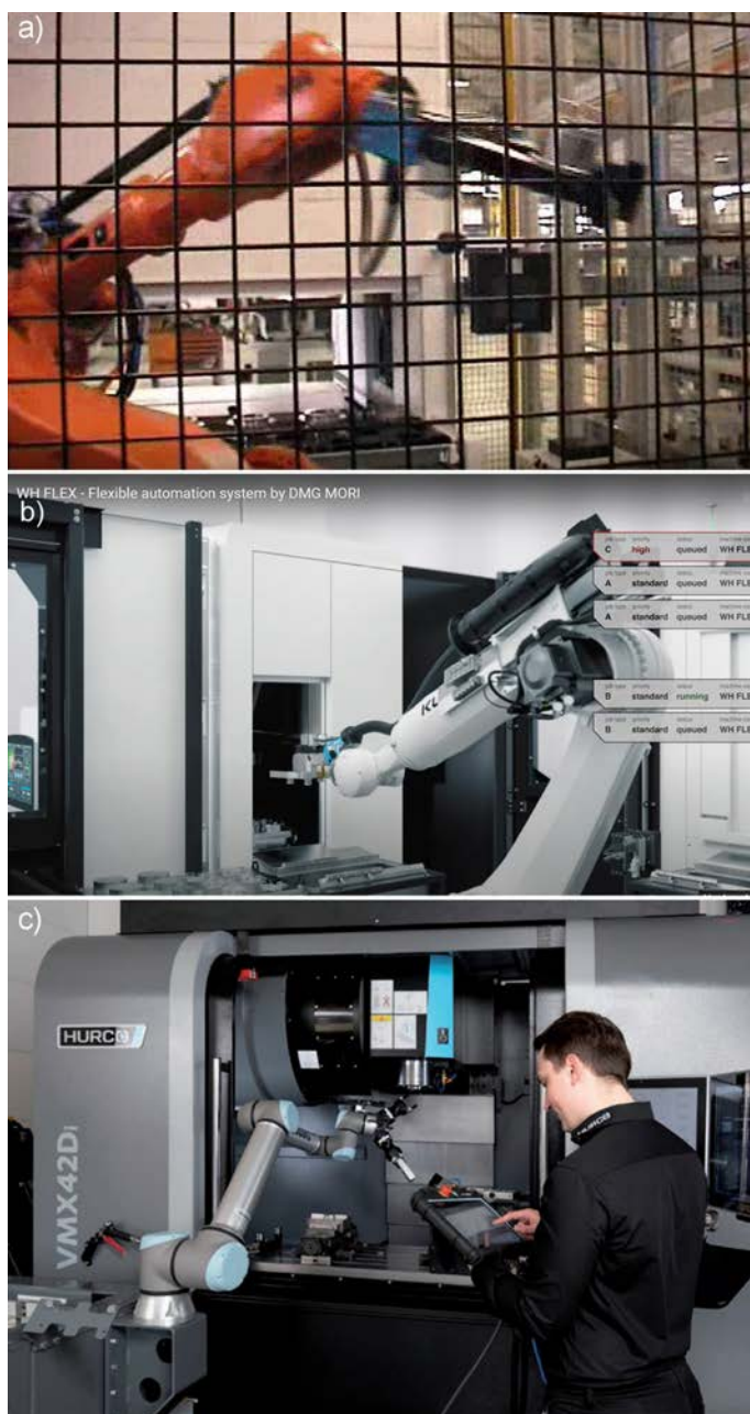
Rysunek 2.26. Przykłady załadowania/wyładowania przedmiotów lub palet przy użyciu: (a) robota przemysłowego wewnątrz gniazda obróbkowego firmy MAUS; (b) robota przemysłowego na stanowisku WH FLEX firmy DMG MORI; (c) cobota w trakcie szkolenia firmy Hurco
