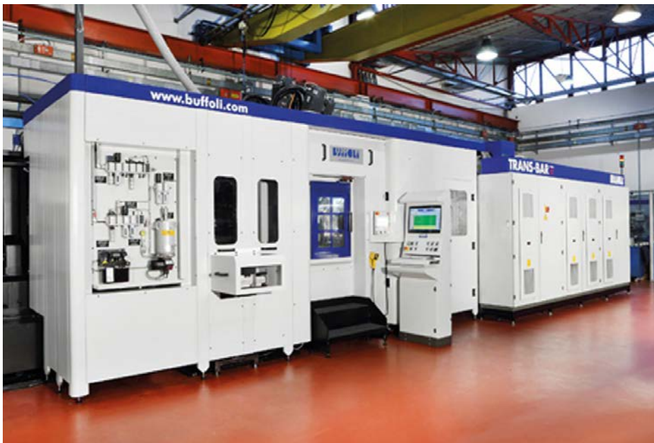
Rysunek 2.33. Wysokowydajna maszyna CNC wyposażona w dwuwrzecionowe zespoły do obróbki dwustronnej [5]
