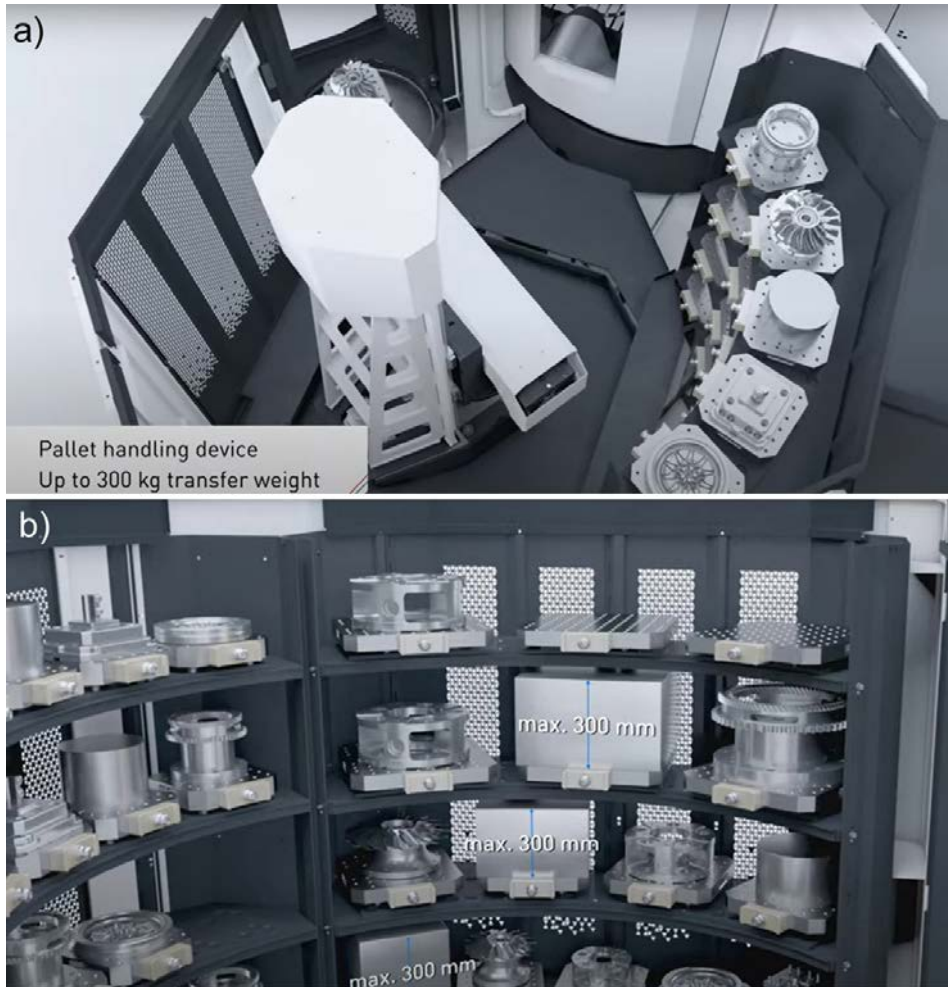
Rysunek 2.23. Systemy załadowczo-wyładowcze firmy DMG MORI: (a) ładowarka, (b) magazyn z paletami (do 40 szt.)
