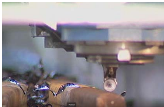
Rysunek 1.1. Struganie dwukierunkowe szyn kolejowych na maszynie CNC – ruch do przodu
