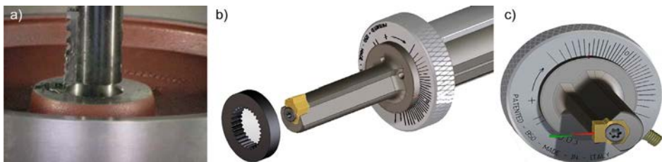
Rysunek 2.18. Przepychanie: (a) rowka na wpust (Reichmann & Soft GmbH), (b) wieńca zębata wkładką dwuzębną, (c) regulacja kątowa wkładki (REV S.R.L. UNIPERSONALE)
