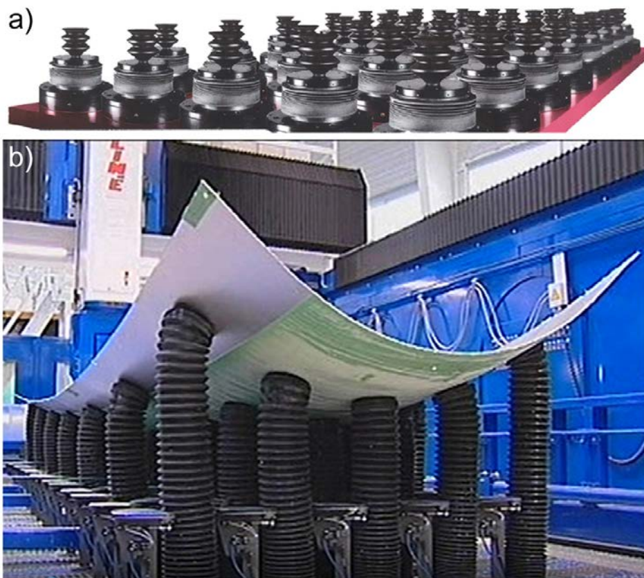
Rysunek 4.21. Mocowanie elastyczne: (a) cienkich płaskich blach firmy Vacusystem, (b) przestrzennych blach kompozytowych firmy Aerospatiale Nantes
