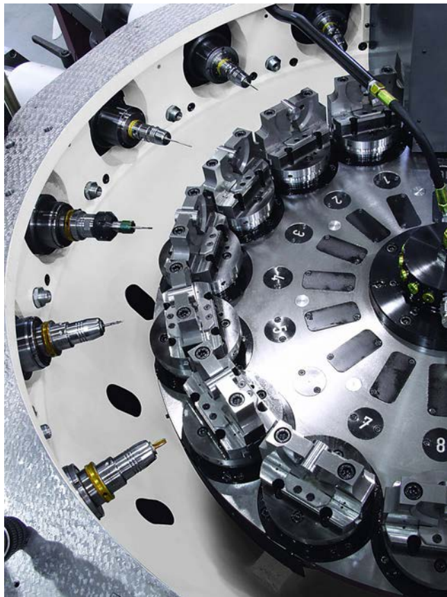
Rysunek 2.34. Maszyna transferowa o ruchu obrotowym [6]
