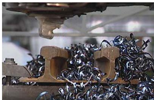
Rysunek 1.2. Struganie dwukierunkowe szyn kolejowych na maszynie CNC – ruch zwrotny
