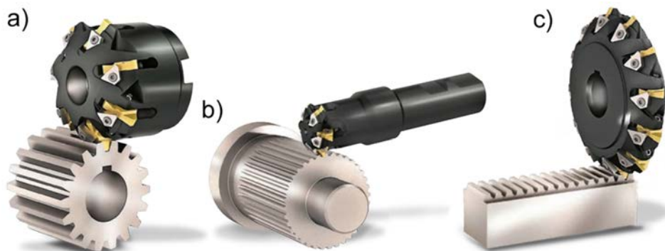
Rysunek 3.39. Kształtowanie uzębienia frezami z płytkami wymiennymi: (a) kół zębatych, (b) wielowypustów, (c) zębatek; firma „Vargus”
