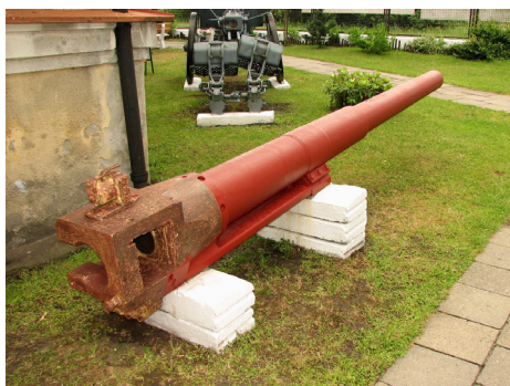
Lufa niemieckiej ciężkiej haubicy polowej sFH 18 kal. 150 mm stanowiącej także uzbrojenie samobieżnej haubicy SdKfz 165 „Hummel”. Fot. T. Blachura
