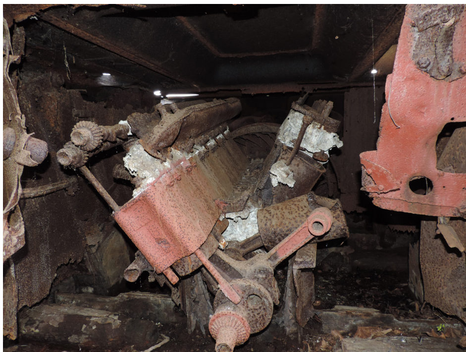
Wypalone wnętrze przedziału silnikowego wozu. Fot. B. Mościpan
