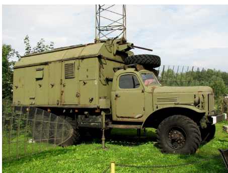
Stacja radiolokacyjna P-15 „Danuta” na samochodzie ciężarowym ZiŁ-157 do namierzania celów nisko lecących. Fot. T. Blachura
