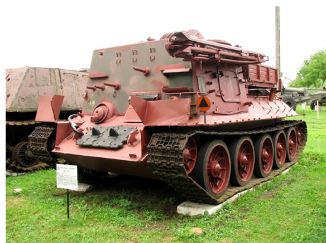
Polskiej produkcji wóz pomocy technicznej WPT-34 na podwoziu czołgu średniego T-34-85. Fot. T. Blachura
