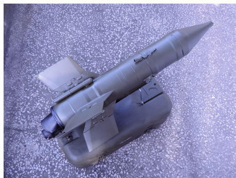
Radziecki przeciwpancerny pocisk kierowany 9M14 „Malutka” z walizkową wyrzutnią przenośną 9P111. Fot. T. Blachura
