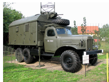
Stacja radiolokacyjna P-15 „Danuta” na samochodzie ciężarowym ZiŁ-157 do namierzania celów nisko lecących. Fot. T. Blachura
