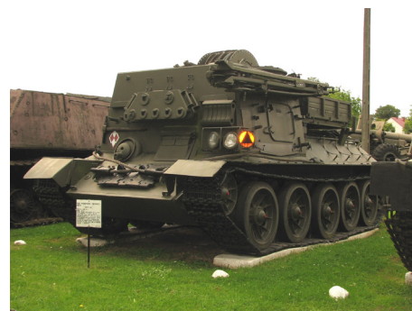
Polskiej produkcji wóz pomocy technicznej WPT-34 na podwoziu czołgu średniego T-34-85. Fot. T. Blachura
