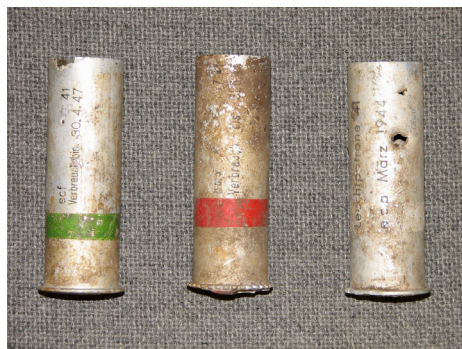
Amunicja kal. 26,65 mm do niemieckich pistoletów sygnałowych Walther LP-34, LP-42. Fot. T. Blachura
