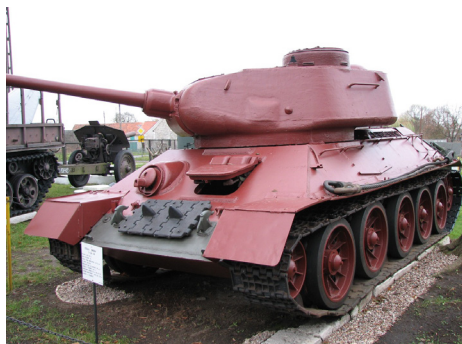
Polskiej produkcji czołg średni T-34-85 tzw. „kaczor”. Fot. T. Blachura
