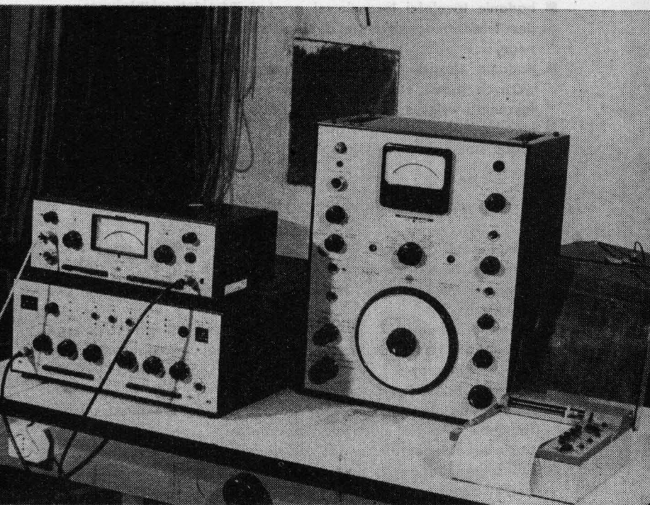
Stanowisko pomiarowe do rejestracji i analizy uderów mechanicznych
