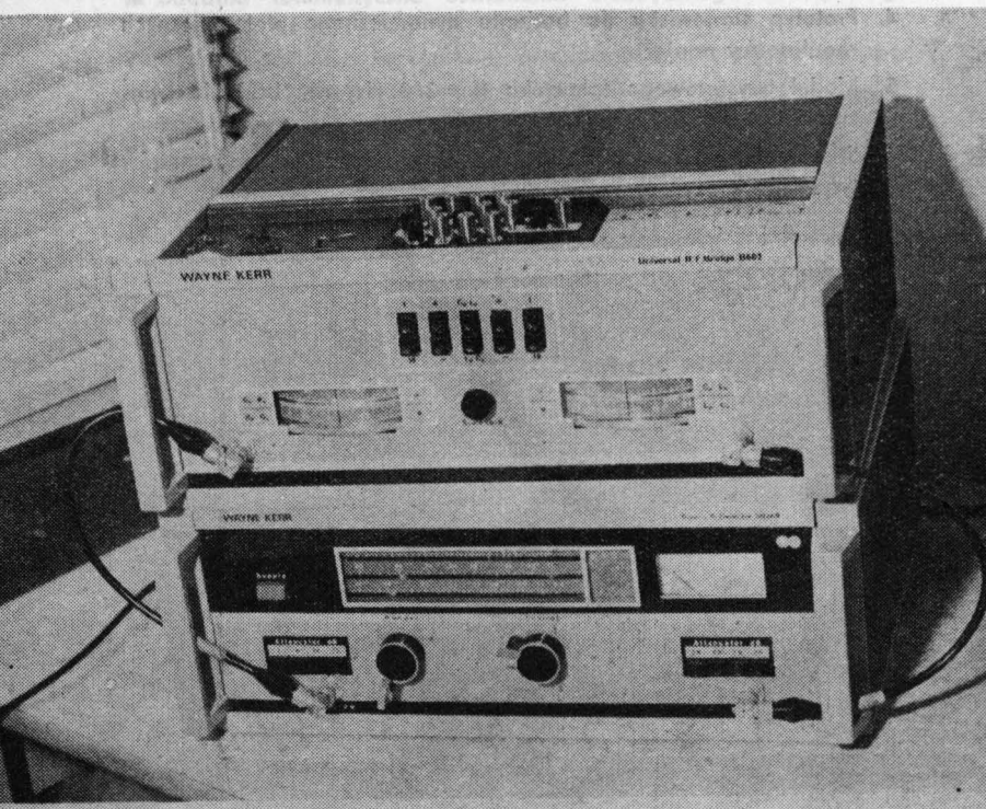
Zestaw do pomiaru admitancji i transmitacji obwodów elektrycznych w zakresie częstotliwości od 30 MHz do 2000 MHz
