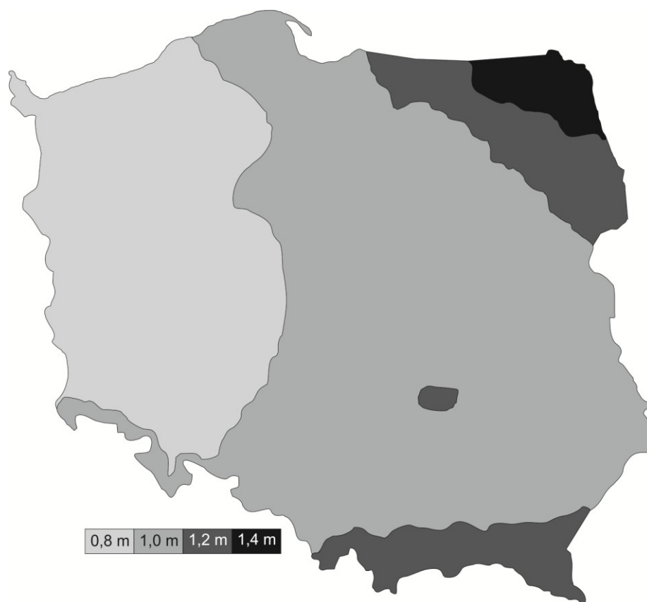
Rys. 1. Strefy przemarzania gruntu na terenie Polski
