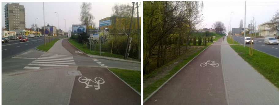
Fot. 1-2. Ścieżka rowerowa N2 z czerwonego asfaltu, ul. Sulechowska Phot. 1-2. N2 bicycle path made of the red asphalt, Sulechowska St.
