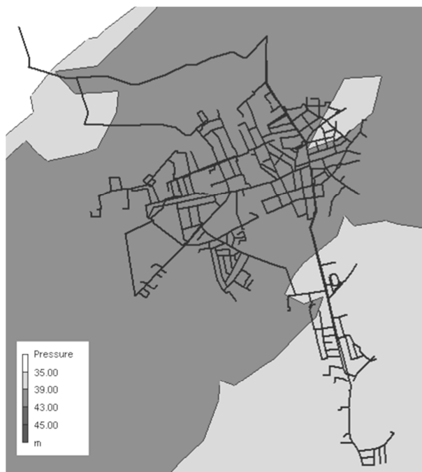
Rys. 2. Rozkład ciśnienia panującego w sieci przy rozborze maksymalnym Fig. 2. Pressure contour plot during maximum demand of water
