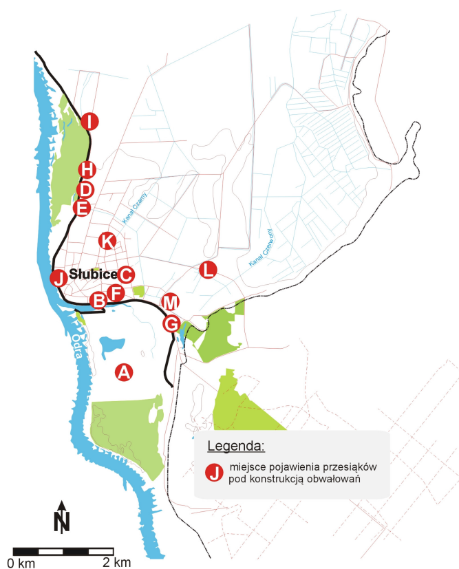
Rys. 8. Miejsca pojawiania się przesiaków pod konstrukcją wałów podczas wezbrania powodziowego w V÷VI.2010 r.
