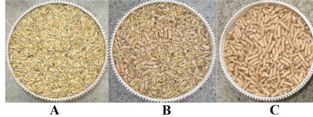
Rys. 2. Rodzaje spalanej paliwa: A – ziarno owsa, B – mieszanka pelletu i owsa, C – pellet drewniany.
