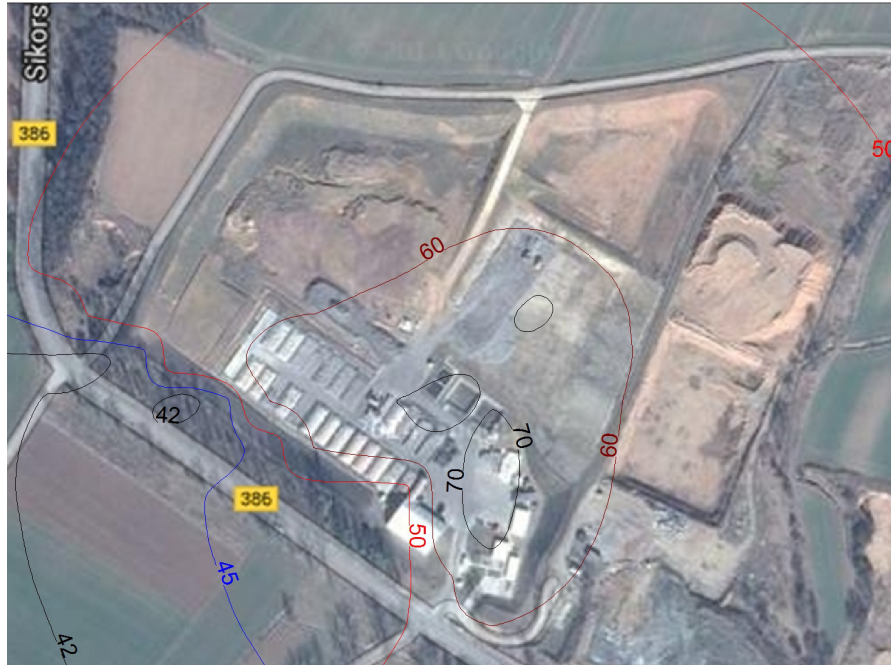
Ryc. 1. Wizualizacja propagacji fali akustycznej w programie ZewHalas v.4.
