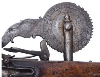
Pistolet-probierz skałkowy (eprowetka) do sprawdzania mocy prochu strzelniczego (czarnego), Europa Zach. (Francja?), 2 połowa XVIII w. (MZG-H-I-220)
