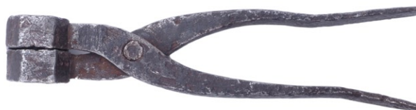
Stalowe szczypce do odlewania pocisków z nieutwardzonego ołowiu do broni odprzodowej o zapłonie kapiszonowym, Europa Zach., połowa XIX w. (LMW-KI-174)
