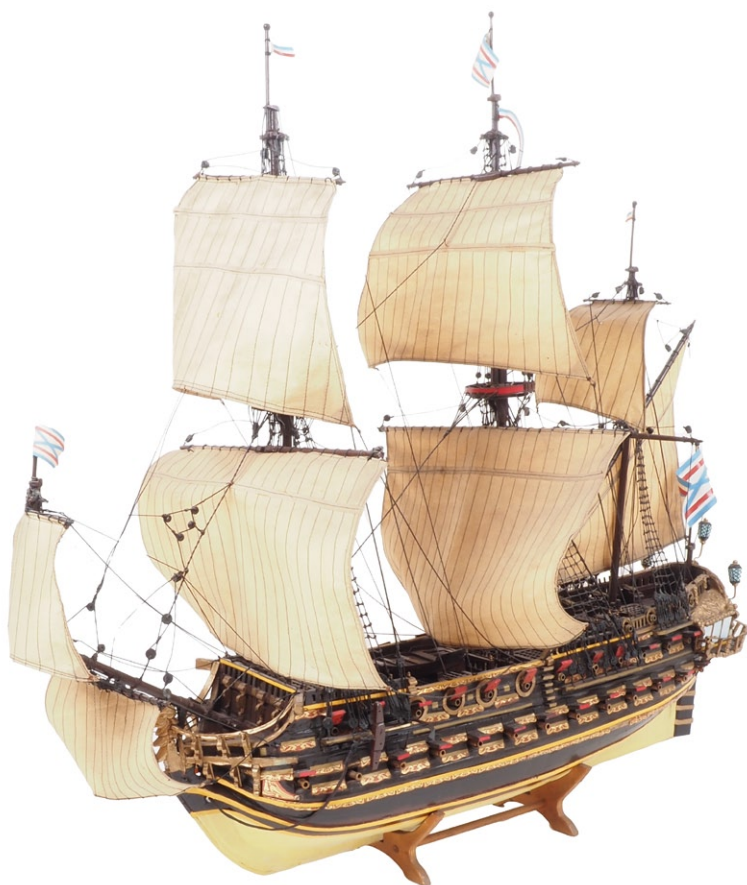
Model okrętu „Przeznaczenie” z czasów panowania cara Piotra Wielkiego - pierwszego liniowca w historii floty rosyjskiej wodowanego w 1700 r. w Woroneżu (500 km od Morza Azowskiego!). Okręt uzbrojony był w 58 dział rozmieszczonych na dwóch pokładach oraz kasztelu rufowym (wyrób współczesny). (LMW-KI-2113)
