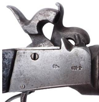
Pistolet kapiszonowy dwulufowy (lufy gwintowane) kal. 12 mm z czytelnymi puncami wytrzymałościowymi, Niemcy, połowa XIX w. (MZG-H-I-219)
