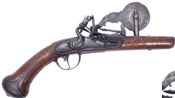
Pistolet-probierz skałkowy (eprowetka) do sprawdzania mocy prochu strzelniczego (czarnego), Europa Zach. (Francja?), 2 połowa XVIII w. (MZG-H-I-220)
