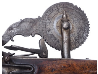
Pistolet-probierz skałkowy (eprowetka) do sprawdzania mocy prochu strzelniczego (czarnego), Europa Zach. (Francja?), 2 połowa XVIII w. (MZG-H-I-220)
