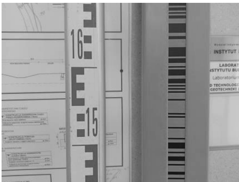
Rysunek 2. Łaty niwelacyjne – aluminiowa po lewej, inwarowa po prawej.
