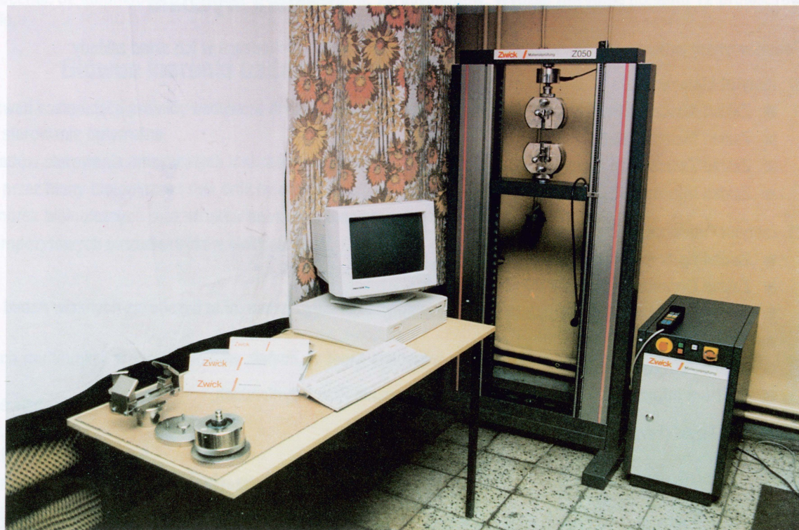
Uniwersalna maszyna wytrzymałościowa sterowana komputerowo firmy Zwick
