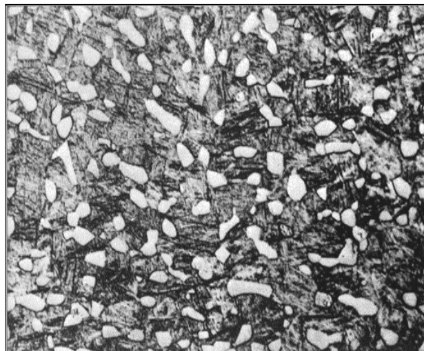
Rys. 1.2. Typowa struktura stopu Ti-6Al-4V po wyżarzeniu, mikroskop świetlny [58]
