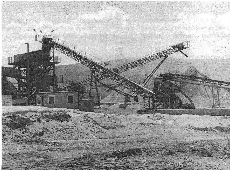
Rys.3. Przesiewacz wstępny i zakład przeróbczy z przesiewaczami i przenośnikami
