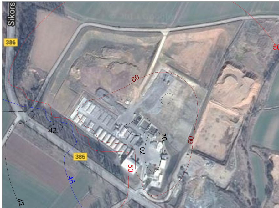
Ryc. 1. Wizualizacja propagacji fali akustycznej w programie ZewHalas v.4. Fig. 1. Visualization of acoustic wave propagation in ZewHalas v.4 program.
