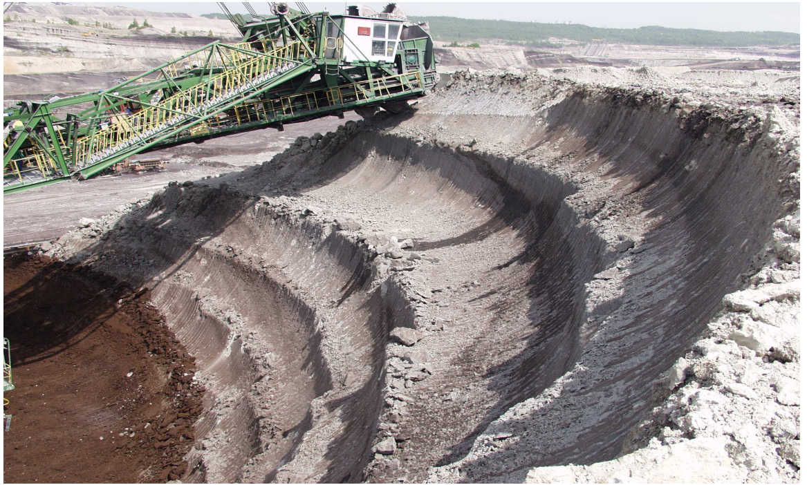
Fot. 1. Urabianie nadkładu koparką [fot. Zajęc, 2004]
