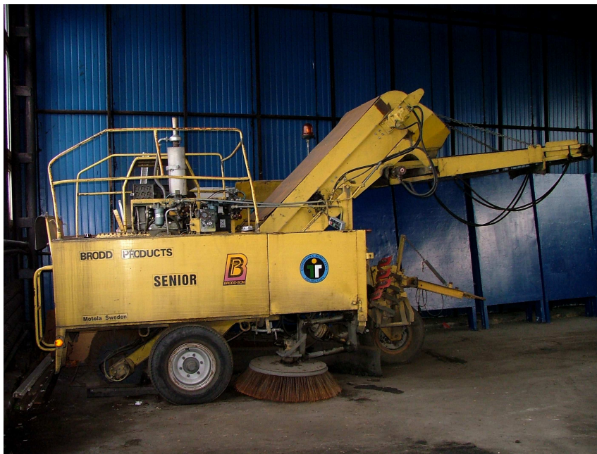
Fot. 2. Pojazd z obrotowymi szczotkami, bez własnego napędu, firmy Brodd
