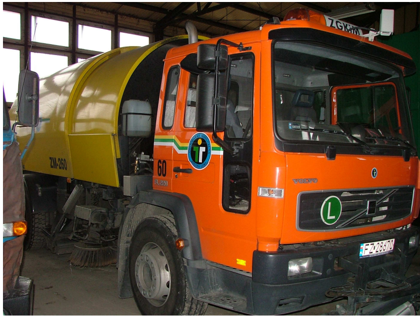
Fot. 1. Pojazd mechaniczny z obrotowymi szczotkami firmy Volvo
