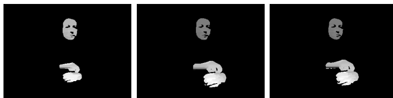
Rys. 3.12. Przykładowe mapy dysparycji dla obrazów z sekwencji odpowiadającej słowu skierowanie wyznaczone z wykorzystaniem algorytmu S. Birchfielda.
