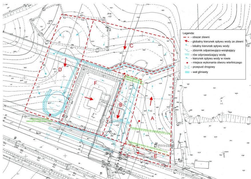
Rys. 7. Koncepcja odwodnienia (skala 1: 1100) Fig. 7. The concept of dehydration (scale 1: 1100)
