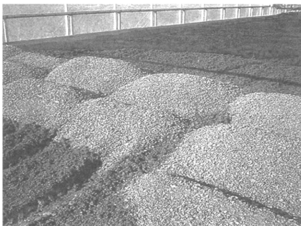
Fot.3. Granulat solarnie wysuszonych osadów ściekowych (fot. autor)
