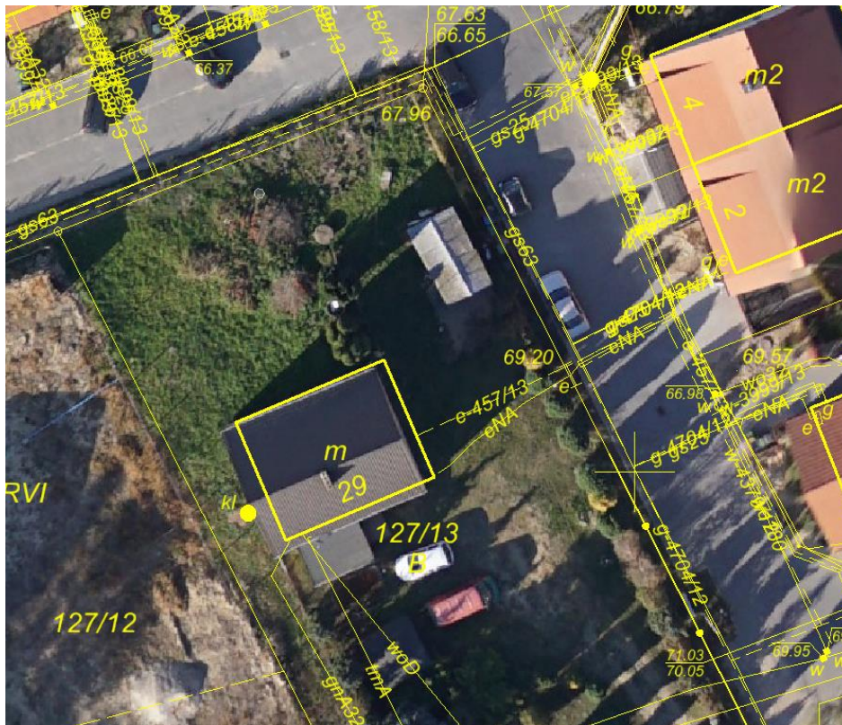
Rys. 8. Weryfikacja obrazu z treścią mapy ewidencyjnej (źródło: opracowanie własne)
