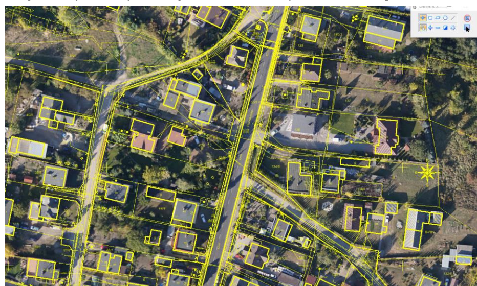
Rys. 7. Weryfikacja obrazu z treścią mapy ewidencyjnej (źródło: opracowanie własne) Fig. 7. Verification of the image with the content of the evidence map (source: own)
