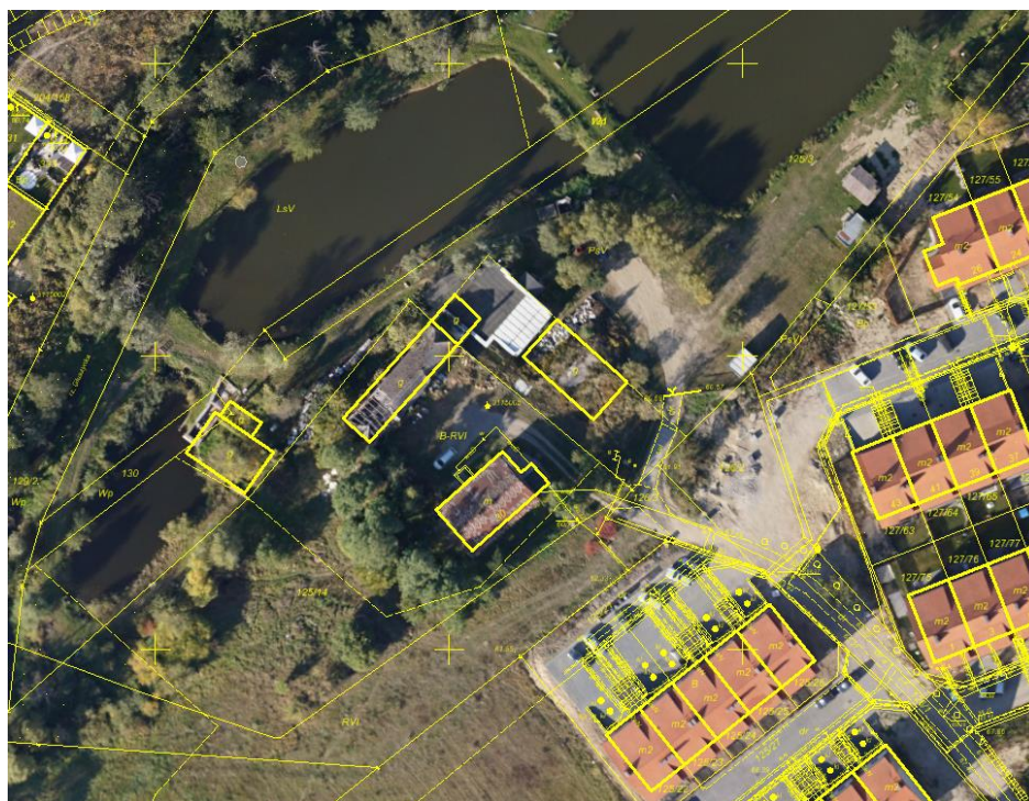
Rys. 6. Weryfikacja obrazu z treścią mapy ewidencyjnej (źródło: opracowanie własne) Fig. 6. Verification of the image with the content of the evidence map (source: own)
