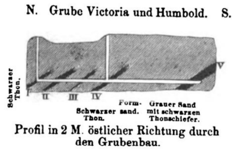
Rys. 14. Przekrój przez złożę węgla eksploatowane w kopalniach „Victoria” oraz „Humboldt” (Zincken, 1867)
