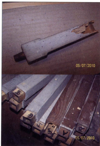
Zniszczone i uszkodzone piszczałki drewniane. Fot. Cz. Chrobak, 2010.
