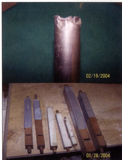
Przykłady uszkodzonych i zniszczonych piszczalek metalowych i drewnianych. Fot. Cz. Chrobak, 2004.
