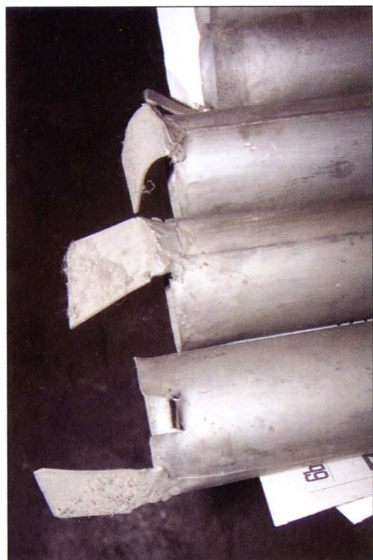
Zdeformowane metalowe piszczalki z dolutowanymi blaszkami. Fot. Cz. Chrobak, 2004.
