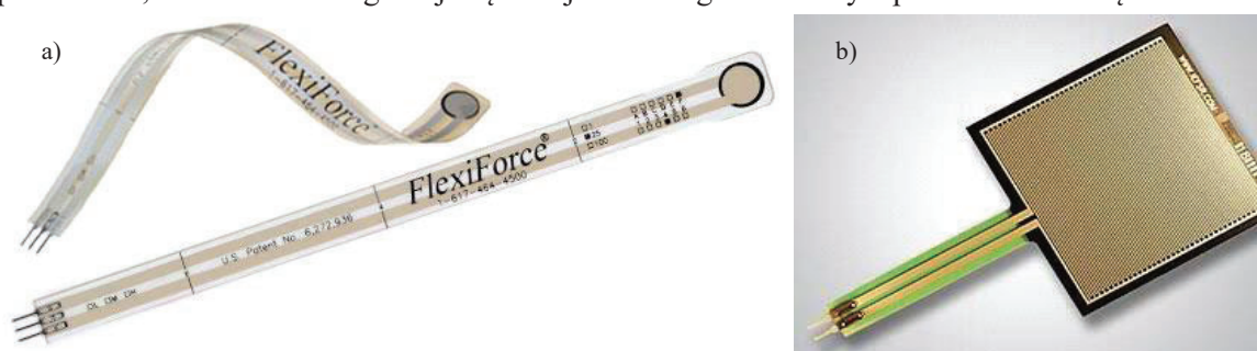
Rys. 2. Czujniki rezystancyjne typu FSR: FlexiForce A201 (a), FSR-406 (b) Fig. 2. FSR resistance sensors: FlexiForce A201 (a), b), FSR-406 (b)
