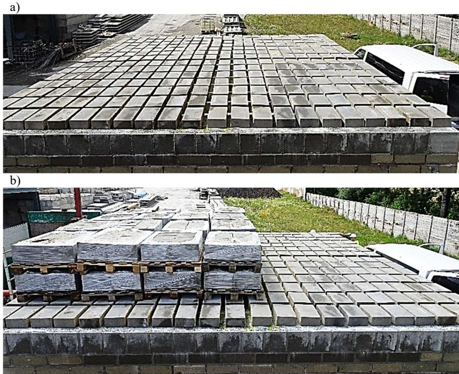
Fig. 10. Load scheme: a) E, b) K, L
