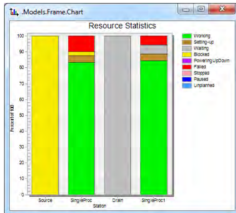
Rysunek 2.12. Poziome wykorzystania zasobów badanego systemu po wprowadzeniu bufora międzystanowiskowego
