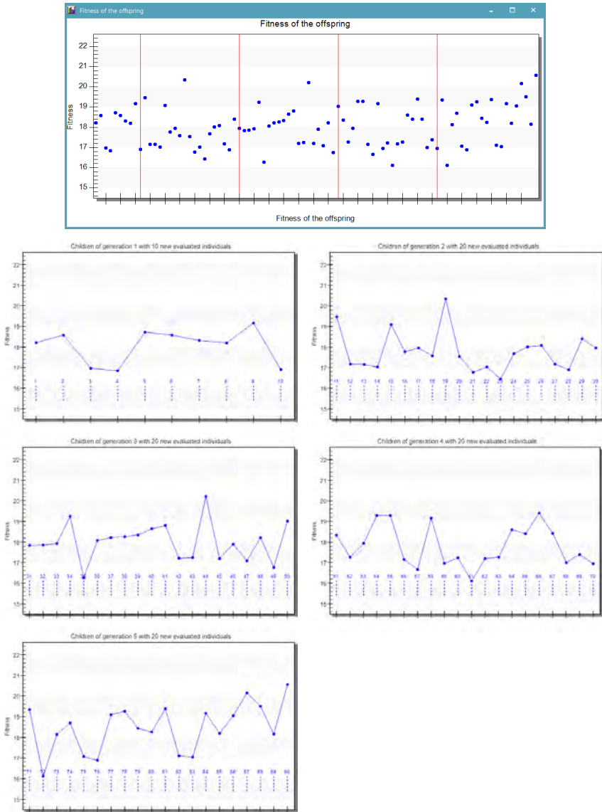
Rysunek 4.4. Wyznaczanie najlepszej wydajności dla kolejnych mutacji potomstwa algorytmu genetycznego alokacji buforów międzyoperacyjnych
