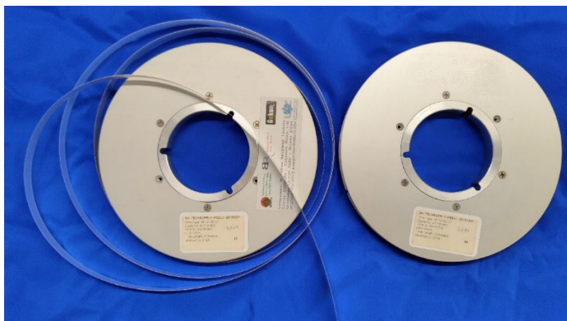
Rys. 2. Szpule taśm nadprzewodnikowych HTS 2G – zasoby własne Laboratorium Nadprzewodnictwa i Inżynierii Materiałowej, Instytutu Automatyki, Elektroniki i Elektrotechniki Uniwersytetu Zielonogórskiego
