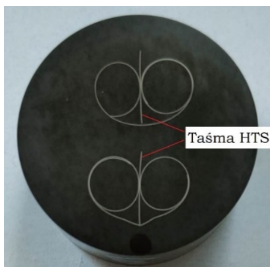
Rys. 4. Próbki przekroju poprzecznego taśm HTS umieszczone w przewodzącej żywicy fenolowej
