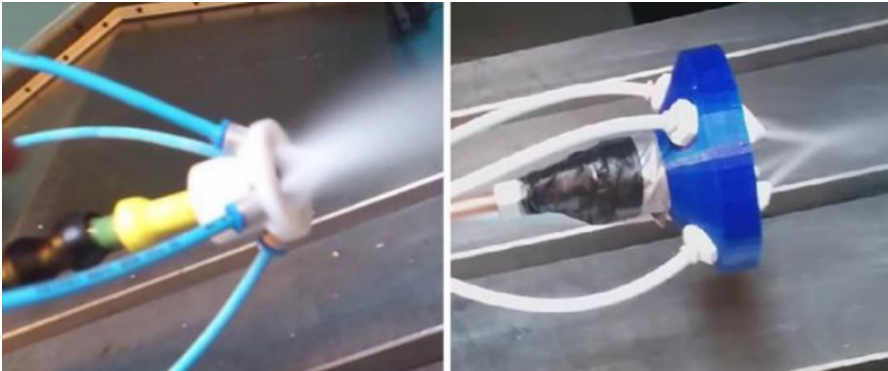
Rys. 3.45. Przykłady układów wielokanałowych dysz zewnętrznych do dostarczania \text{LN}_2 i \text{LCO}_2
