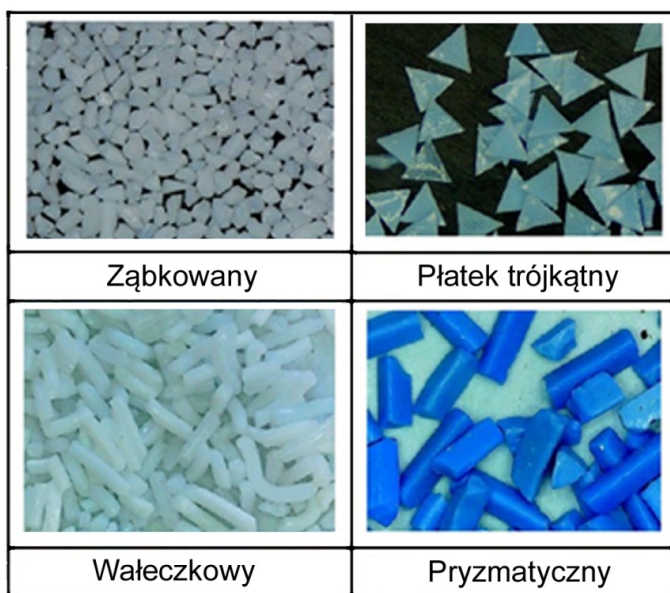
Rys. 2.3. Kształty ziaren spiekanych (firma „Shandong Renwa Abrasive Tech.”)
