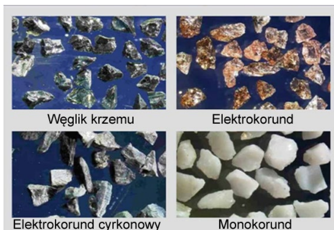
Rys. 2.2. Ziarna ściernie po rozdrobnieniu mechanicznym (na podstawie [34])
