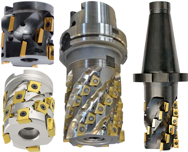
Rys. 1.53. Frezy „jeżowe” o wydłużonych krawędziach skrawających różnych firm
