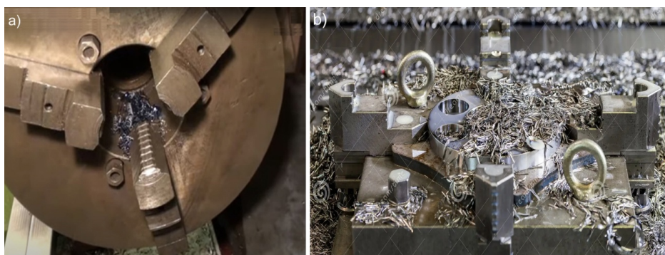
Rys. 3.10. Niewielkie odłamki wiórów wewnątrz uchwytu tokarskiego (a) i frezarskiego (b)
