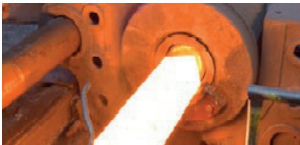
Rys. 2. Wprowadzenie wlewka do matrycy prasy [fotografia własna]
