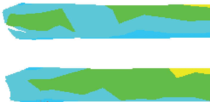
Rys. 16. Widok przekroju ścianki rury z dowalcowanym kielichem wytwarzanej z: a) standardowego wsadu, b) tutei walcowanej według zmodyfikowanej technologii [oprac. własne]
