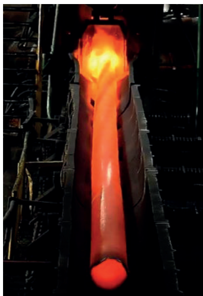
Rys. 6. Rura w procesie walcowania na walcierce pielgrzymowej [fotografia własna]
