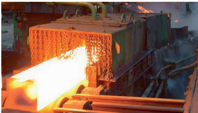
Rys. 1. Usuwanie zgorzeliny w zbijaczu hydraulicznym [fotografia własna]
